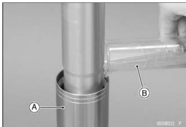
A. Vasemman etuhaarukan ulkoputki B. Haarukkaöljy
