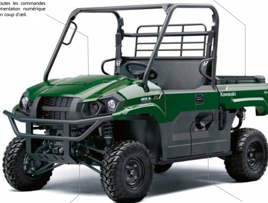
La suspension à double triangulation est utilisée à l'avant et à l'arrière pour permettre à chacune des roues de franchir les obstacles avec un minimum d'effort sur le châssis.
