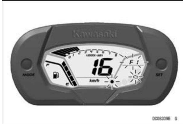
Indításgátló erősítő visszajelző/"Innb" felirat/piros figyelmeztető lámpa
