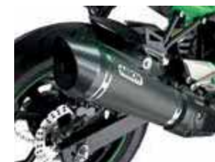
Tłumik Arrow z karbonową osłoną termiczną
